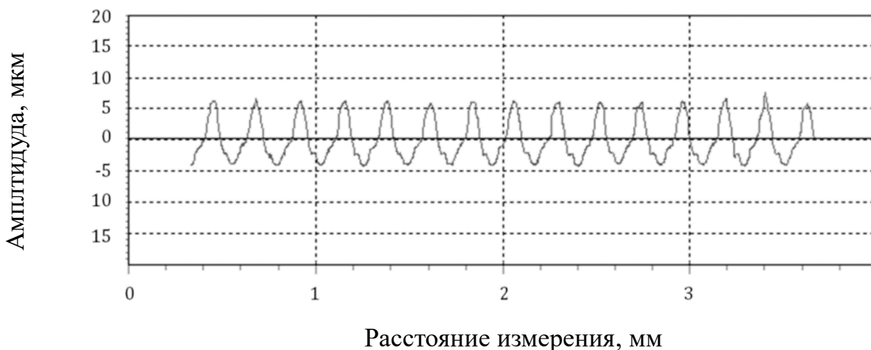
Рисунок 6 – Профиль поверхности обработанного образца толщиной R_{cp} 2,90 \pm 0,2 мкм.
