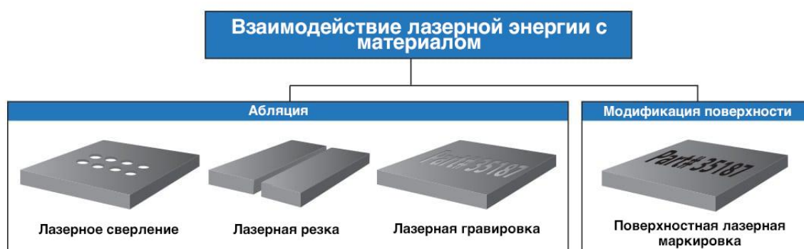
Рисунок 1 – Взаимодействие лазерной энергии с материалом
